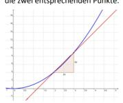
Die Berechnung der Steigung erfolgt mit dem Differenzenquotienten. Dies entspricht der bekannten Berechnung mittels Steigungsdreieck
